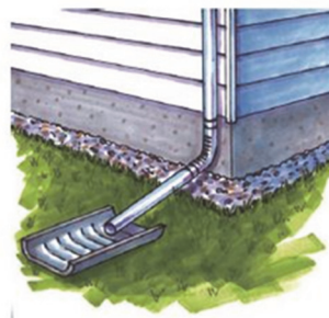
Un déflecteur d'eau de pluie en béton
